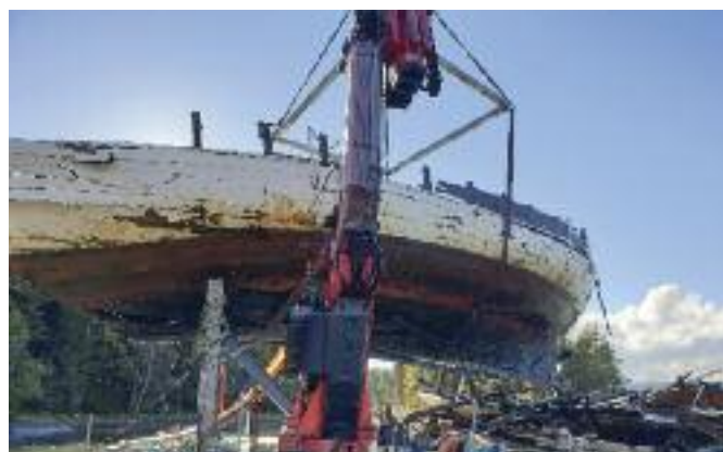
HOGGING: Slutten på et altfor langt liv. FOTO: KAMBO MARINA
