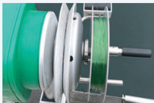
Fiskehjulet kan monteres både på aluminiumskive og garntrommel.
