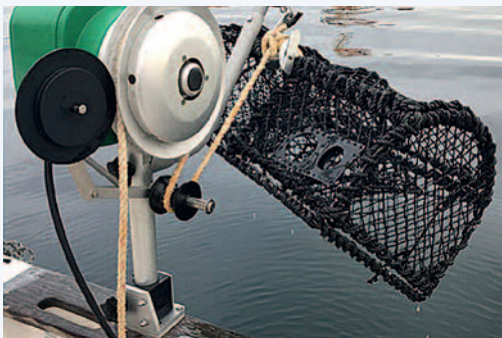
Teinehaling på aluminiumskive med to kilspor, kort bom og presshjul.
